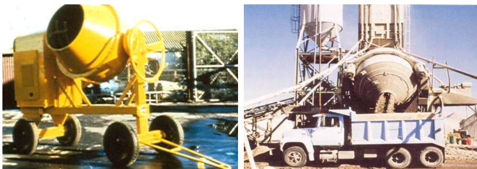
شکل ۲ انواع مخلوط‌کن‌های کج شونده
