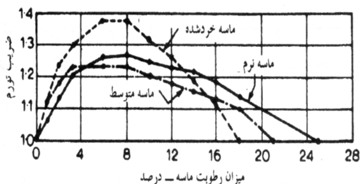
شکل ۲ اثر رطوبت ماسه در حجم آن (به عنوان مثال)
